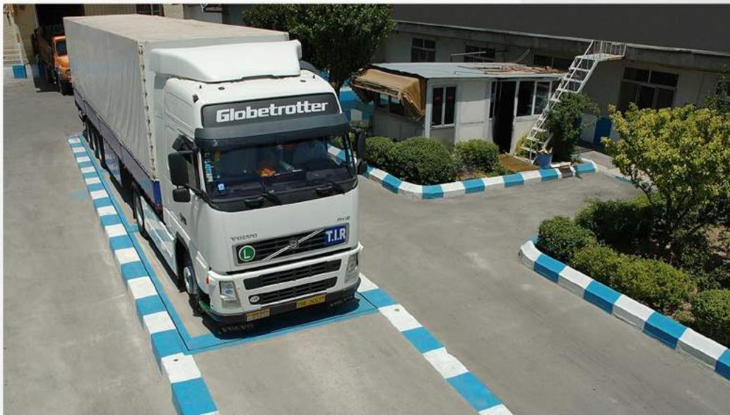
ابعاد باسکول بر حسب نوع استفاده از آن می‌تواند متفاوت باشد. برای مثال به طور معمول باسکول تریلی‌کش با ابعاد ۳ در ۱۶ متر طراحی و تولید می‌شود و باسکول‌های کامیون‌کش با ابعادی نظیر ۳ در ۸ متر ساخته می‌شوند. بر حسب نوع استفاده‌ای که می‌خواهیم از این باسکول‌ها داشته باشیم، این اعداد می‌توانند متفاوت (بیشتر یا کمتر) باشند. ظرفیت باسکول نیز از مواردی است که باعث ایجاد تفاوت میان باسکول‌های مختلف می‌شود.
